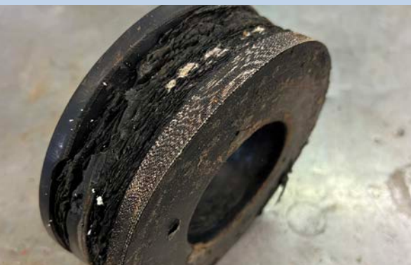
Schadhafte Gleitringdichtung – geringerer Durchsatz
