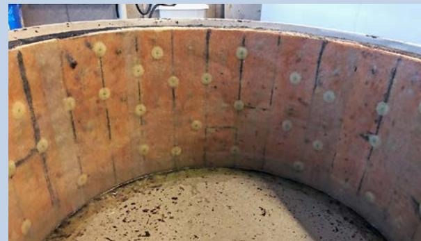
Beschichtungsversuche für Innenisolationen von Schlammbehältern
