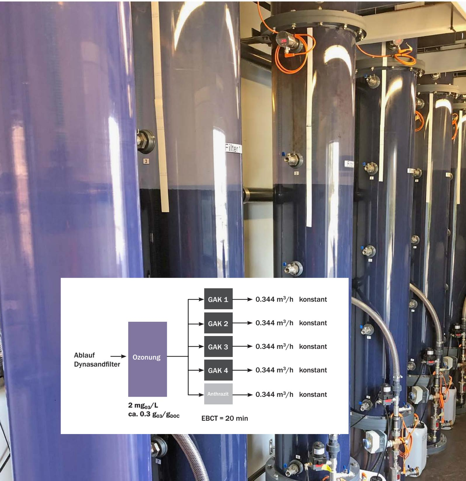
Innenraum Pilotanlage; Kolonnen mit verschiedenen granulierten Aktivkohlen (GAK) mit Prozessschema
