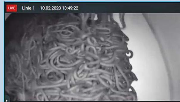
Schlammpellets nach der Extrusion
