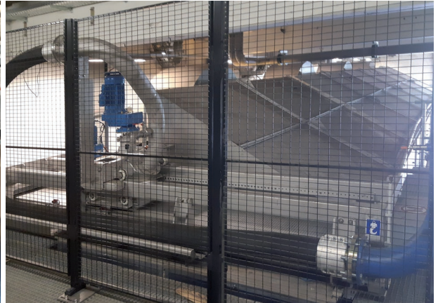
Quer zur Trocknungsstrasse eingebrachter Pelletierer
