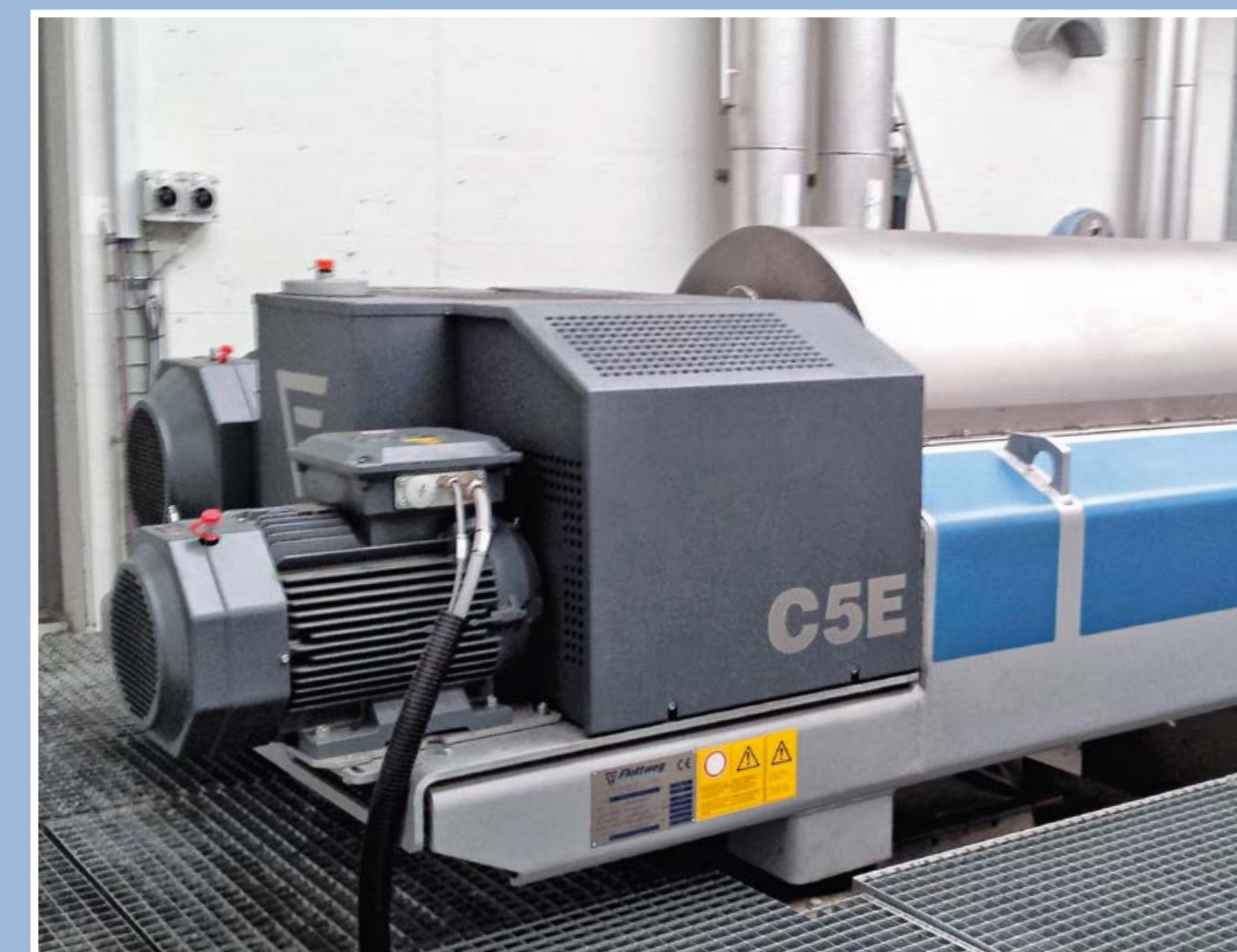
Dekanter zur Schlammentwässerung
