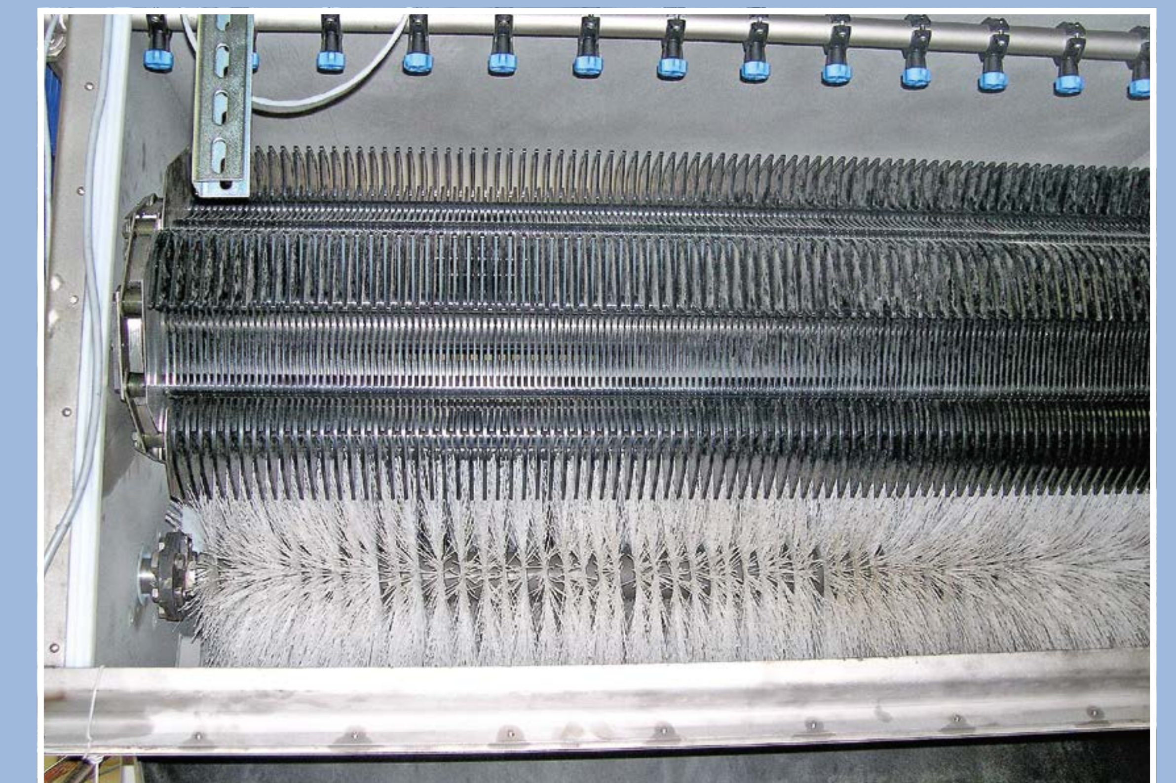
Reinigungsbürsten am oberen Ende des Rechens
