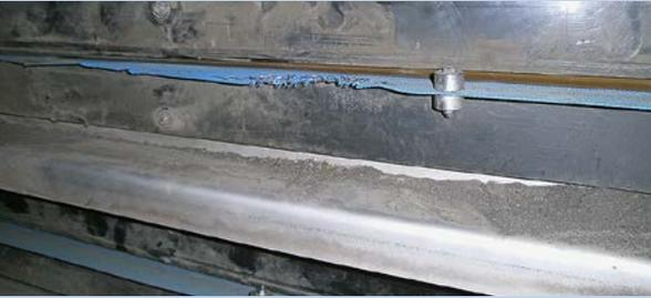
Banddefekt auf der Trocknungslinie 1
