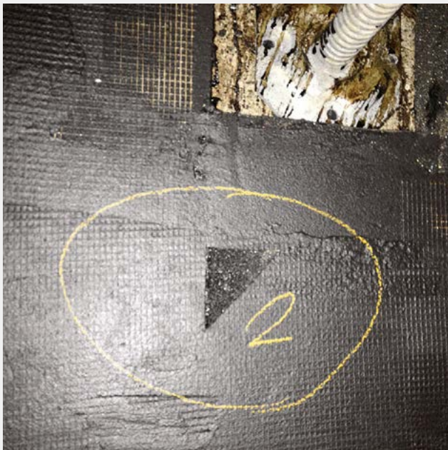
Fig. 12 Probestelle zur Haftkontrolle der Deckschicht
