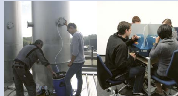
Probenahme am Abluftkamin auf dem Wäschergebäude und Geruchsmessung am Olfaktometer in Rapperswil
